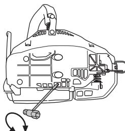
Когда топливо полностью израсходовано, масляный бак также обычно бывает почти пуст. Обязательно заполняйте масляный бак при каждой заправке пилы.
