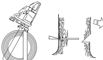
Закончить основной пропил нужно параллельно линии направляющего пропила так, чтобы расстояние между ними составляло около 1/10 диаметра ствола. Нераспиленный участок ствола называется полоса разлома (недопил).
