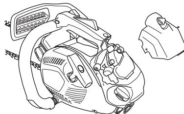
Для более тщательной чистки фильтр следует помыть в воде с мылом.
