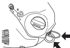
б) Используйте соответствующие карабины для непрямого (например, с помощью стропа) и прямого (например, непосредственно в точке крепления) присоединения пилы к обвязке оператора.
