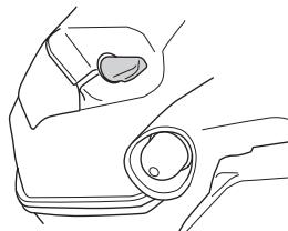
Используйте ту же процедуру, что и при холодном двигателе, но без постановки воздушной заслонки в закрытое положение.
