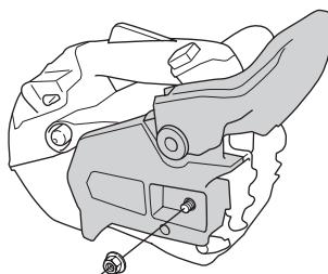
Установите пильное полотно на специально предназначенные болты. Установите полотно в самое заднее положение. Оденьте цепь на ведущую звездочку и вставьте ее хвостовики в паз пильного полотна. Начинайте с верхней стороны пильного полотна.
