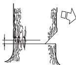
Вставьте зубчатый упор (если установлен) сзади надреза. Работайте на полном газу и вводите пильное полотно в ствол дерева постепенно. Следите за тем, чтобы верхушка дерева не начала перемещаться в направлении, противоположном предполагаемому направлению падения.
